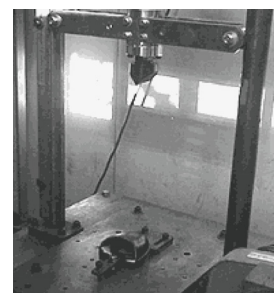
衝撃試験装置（落下前）
